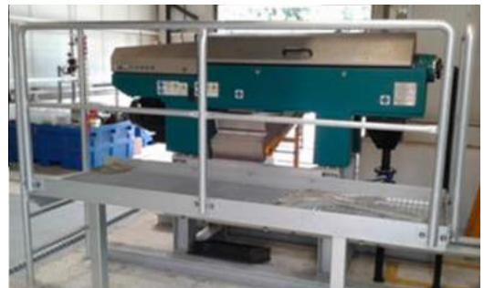
Die Anlage hat eine Leistung von 20 m<sup>3</sup>/h und ist so konzipiert, dass sie auf eine Kapazität von 800 m<sup>3</sup>/d erweitert werden kann. Sie ist in der Lage, verschiedene Inhaltsstoffe wie Fette, lipophile Stoffe, chemischen Sauerstoffbedarf (CSB), Tenside und Aluminium zu behandeln.
