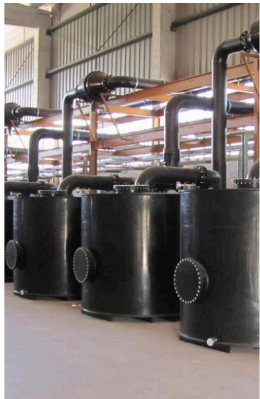
Die Anlage ist in der Lage, Schadstoffe wie Cr(VI) und halogenierte Kohlenwasserstoffe effektiv zu behandeln. Sie hat eine Gesamtleistung von 320 m<sup>3</sup>/h.
